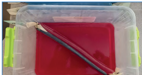
Figura 8. Vasos simulados colocados sobre la base de gelatina.
